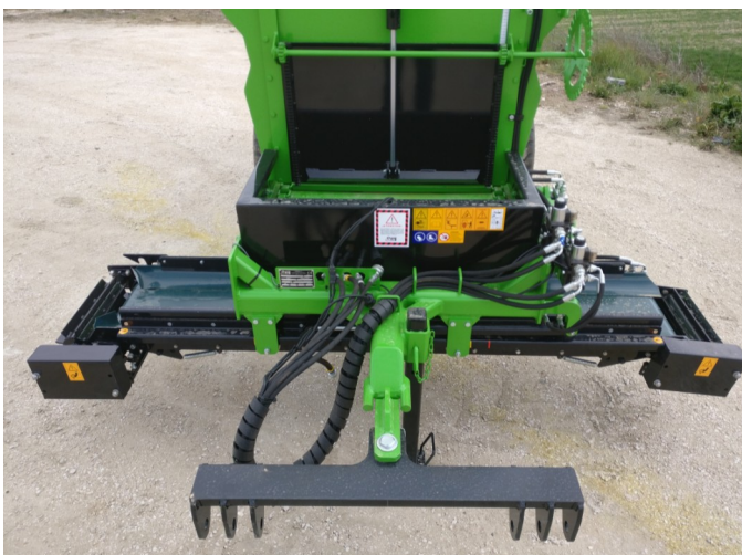
Doble cinta desplazable hidráulica con rodillos lanzadores
