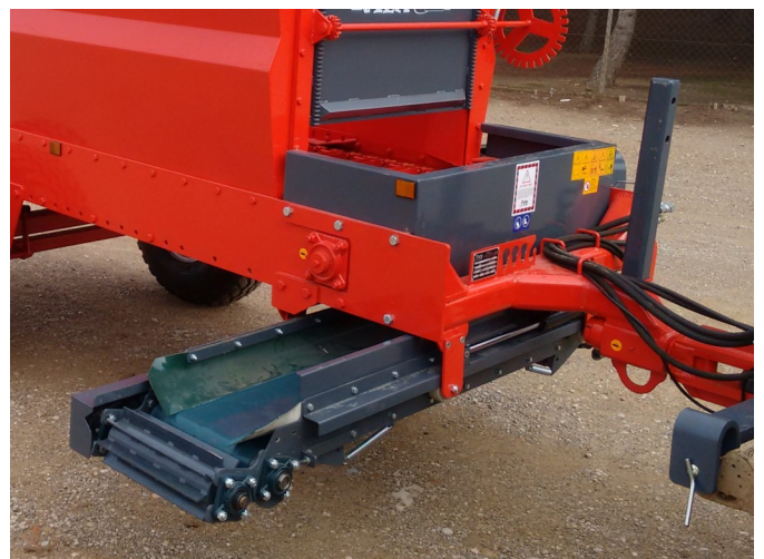
Cinta desplazable hidráulica a la derecha con rodillo lanzador
