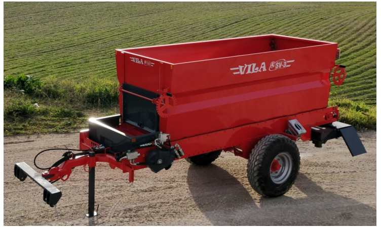
Máquina equipada con doble trampilla. Caída libre delante. Grupo de discos y orientador en la parte posterior.
