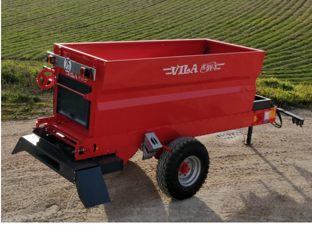
Máquina equipada con doble trampilla. Caída libre delante. Grupo de discos y orientador en la parte posterior.
